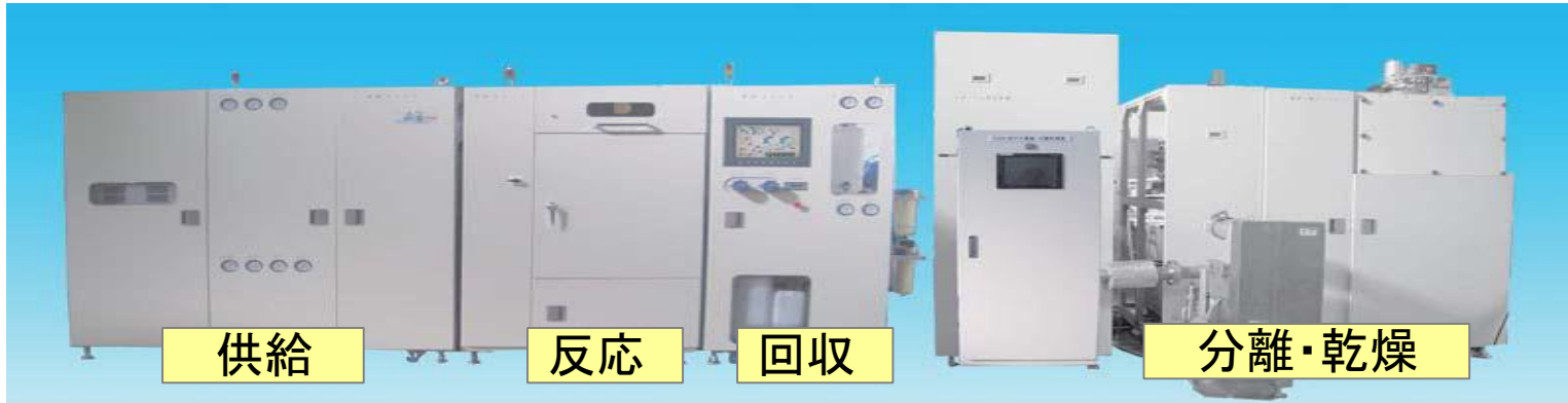
図7.大型流通式超臨界水熱合成装置外観写真
