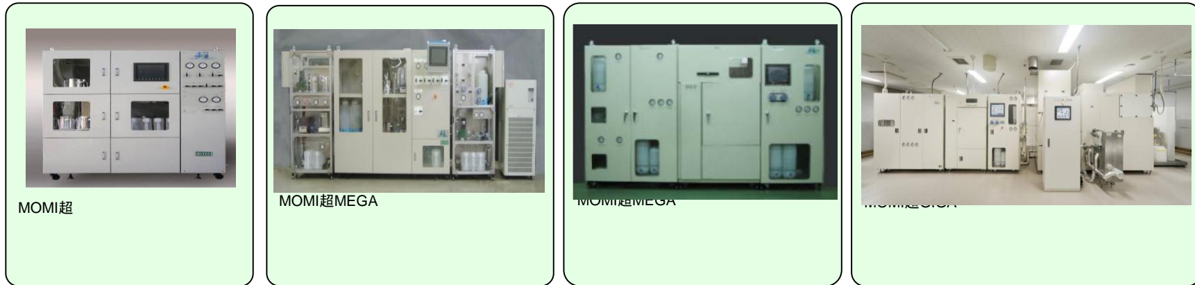
図6. プロジェクト期間中に開発した連続式超臨界水熱合成装置の外観写真
